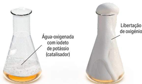
**Fig. 8** A água-oxigenada decompõe-se rapidamente na presença de iodeto de potássio.
