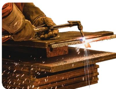
**Fig. 38** Maçarico de oxiacetileno.
