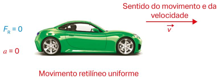
**Fig. 41** Numa trajetória retilínea, quando a velocidade é constante, a aceleração e a resultante de forças são nulas.
