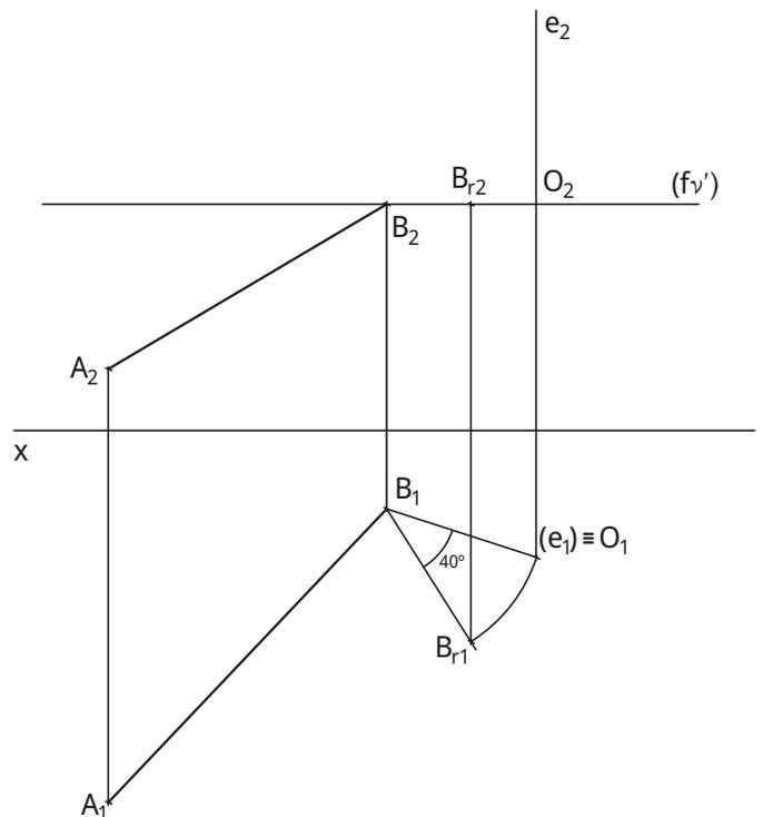
A projeção frontal de  $B_r$  estará sobre o traço do plano horizontal onde se dá a rotação, ou seja, com a mesma cota de  $B_2$ .
