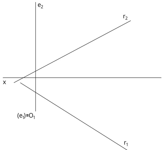
Uma vez determinado o eixo de rotação, o processo é equivalente ao já estudado, mas com rotações que se desenvolvem sobre planos horizontais e arcos de rotação em verdadeira grandeza em projeção horizontal.
