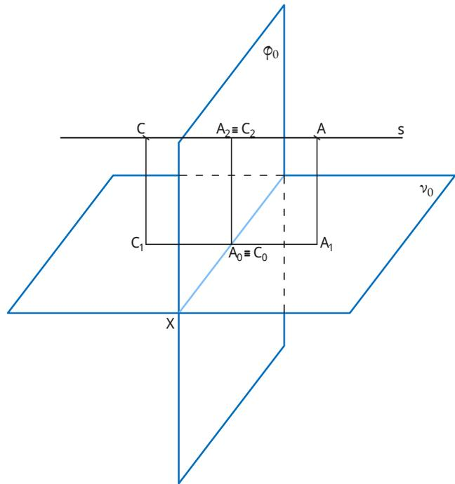
Deste modo, no plano do desenho, as projeções frontais dos pontos **A** e **C** são coincidentes, e as projeções horizontais são simétricas relativamente ao eixo **x**. No caso do ponto **C**, dado o afastamento negativo, este é marcado acima do eixo **x**, ao contrário do afastamento do ponto **A**, que, sendo positivo, é assinalado abaixo do eixo **x**.
