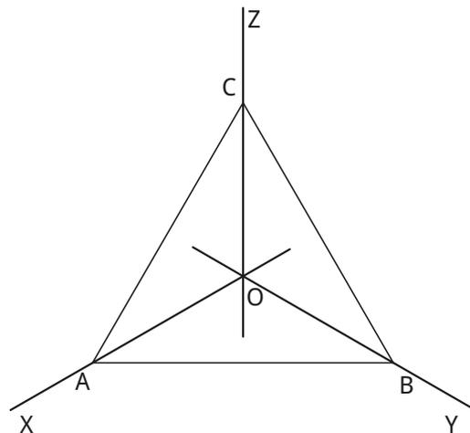
Neste caso, opta-se, primeiro, pelo rebatimento do plano coordenado  $xOy$ . Isto permitirá, no mesmo processo, rebater dois eixos coordenados (eixo  $x$  e eixo  $y$ ), usando como eixo de rebatimento (charneira) o lado  $[AB]$  do triângulo fundamental.
