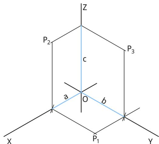
A esta condição dá-se o nome de **coeficiente de redução** ou **coeficiente de deformação**. Estes coeficientes variam conforme o ângulo que os eixos coordenados formam com o plano axonométrico. Deste modo, numa isometria, os coeficientes de redução são iguais nas três coordenadas, enquanto, na trimetria, são todos diferentes.
