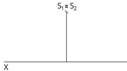
Assim, as projeções **S<sub>1</sub>** e **S<sub>2</sub>** são coincidentes, representadas acima do eixo **x**.
