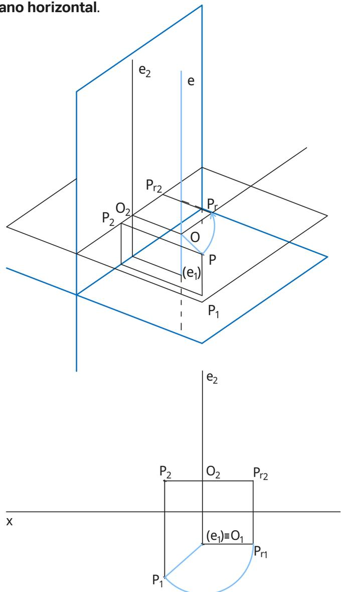
Considera, agora, um exemplo de rotação de um ponto, mas cujo **eixo de rotação** é uma **reta de topo** (reta **e**). Neste caso, o **arco de rotação** desenvolve-se sobre um **plano frontal**, perpendicular ao eixo de rotação.
