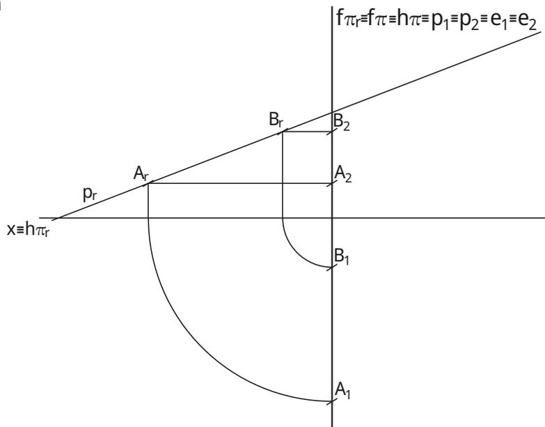
Já o traço frontal da reta estará sobre o traço frontal do plano. A sua determinação é feita na interseção da reta rebatida com o traço frontal do plano (neste caso, coincidente com o eixo do rebatimento e, por conseguinte, com o traço frontal do plano rebatido).
