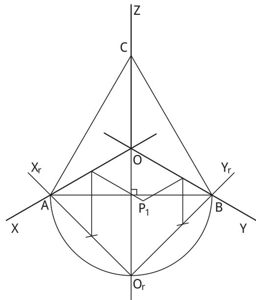
Para isto, basta repetir o processo, mas rebatendo um dos planos coordenados que contenha o eixo  $z$ . Ao optar-se, por exemplo, pelo rebatimento do plano  $xz$  sobre o plano axonométrico, usar-se-á como charneira o lado  $[AC]$  do triângulo fundamental, e o processo é idêntico ao praticado anteriormente, mas com o segmento  $[AC]$  como eixo, conforme representado no desenho.
