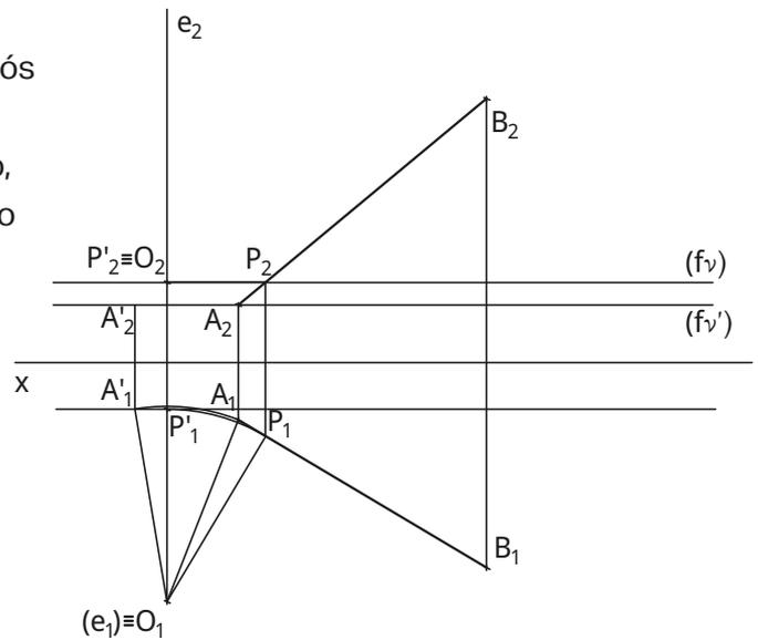
De seguida, é feita a rotação dos extremos do segmento. Unindo  $O_1$  a  $A_1$ , traça-se um arco com o raio correspondente ao segmento **[AO]**, com a mesma amplitude do arco de rotação do ponto **P**, até intersestar a projeção horizontal da reta de suporte do segmento **[AB]**. Aí, tem-se a projeção horizontal de **A** após a rotação.
