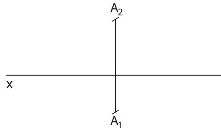
Determinando  $h_2$ , que contém o ponto **A**, determina-se o seu traço frontal. Depois, é possível determinar a projeção horizontal da reta, que está definida por dois pontos: o seu traço frontal e o ponto **A**. Uma vez que as retas horizontais de um plano possuem a mesma direção dos seus traços, o traço horizontal de  $\alpha$  será paralelo a  $h_1$  e concorrente com  $f_\alpha$  no eixo **x**.
