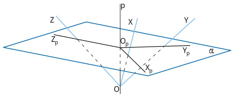
Observando os dois exemplos, pode verificar-se que, apesar da posição do plano de projeção (contendo ou não a origem do referencial), a representação obtida não sofre qualquer alteração. Isto permite concluir que o resultado da projeção não varia com a posição relativa do observador ou do plano de projeção, ao invés da perspectiva cónica.
