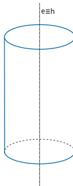
Tal como nos prismas, tratando-se de um cilindro reto ou de um cilindro oblíquo, a sua altura é sempre medida entre bases, e segundo um segmento de reta perpendicular às mesmas, ou seja, medindo a distância entre os planos das bases.
