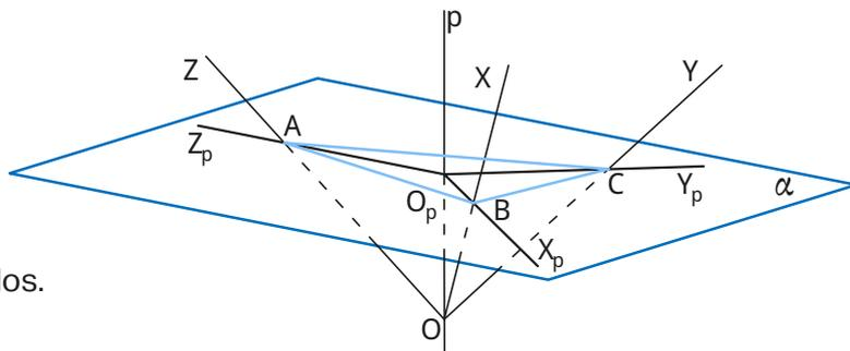
Neste caso, os pontos **A**, **B** e **C** são os pontos de interseção do plano de projeção (plano axonométrico) com cada um dos eixos coordenados.
