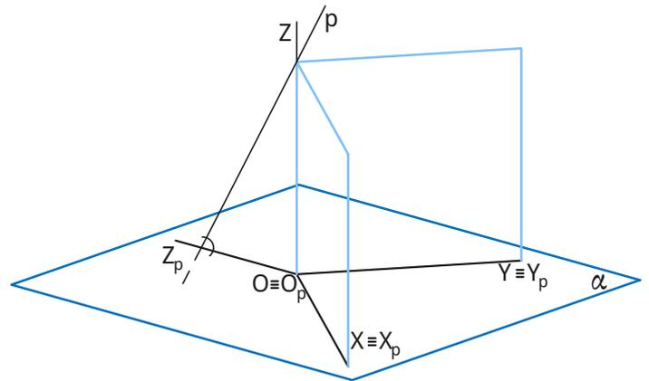
Tal como numa axonometria ortogonal, a posição do plano de projeção não é fixa, podendo este ser coincidente com um dos planos de coordenadas, ou somente paralelo a um destes, não havendo alterações no resultado final da projeção.
