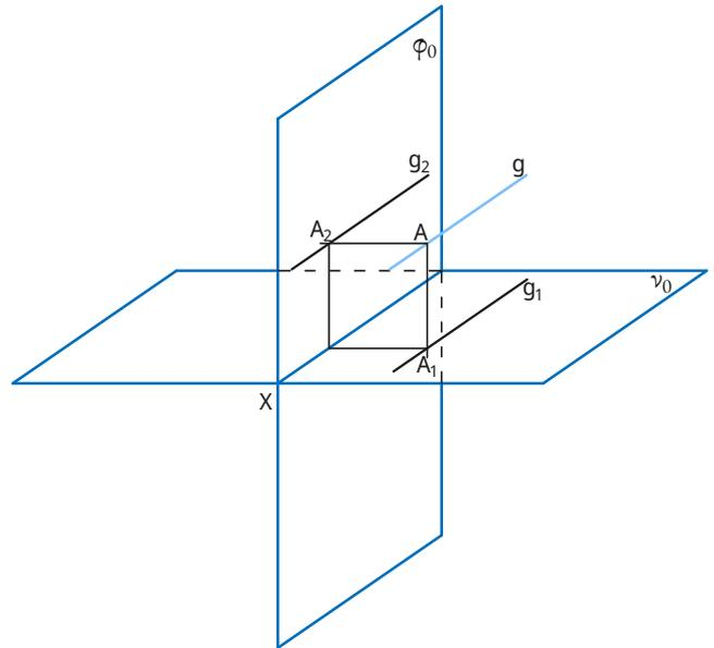
Em dupla projeção ortogonal, uma reta fronto-horizontal tem as suas projeções paralelas ao eixo **x**, pois são retas paralelas à interseção dos dois planos de projeção (que corresponde ao eixo **x**).
