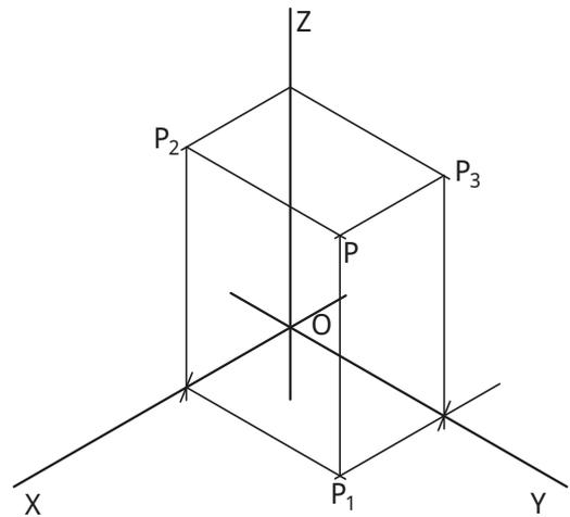
O ponto de concorrência das perspectivas das três retas projetantes do ponto **P** resulta na perspectiva axonométrica do próprio ponto.
