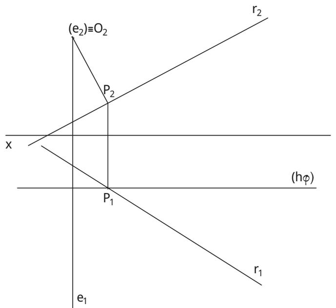
Assim, determinado o eixo, une-se a projeção frontal do ponto **O** (origem da rotação) à reta **r**, segundo uma perpendicular. Daí resulta o ponto **P**. O segmento **[OP]** é perpendicular à reta **r** e ao eixo de rotação.
