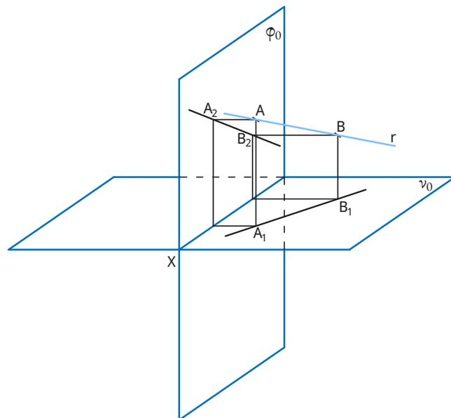
Assim, em dupla projeção ortogonal, dados dois pontos, e representadas as projeções destes, é imediatamente possível determinar as projeções de uma reta por estes definida.
