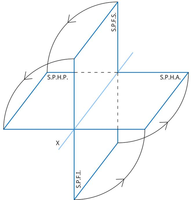
Este rebatimento resulta numa representação bidimensional, onde é marcado o eixo  $x$ , e **acima** deste marcam-se as **cotas positivas** e **afastamentos negativos**. Ao invés, **abaixo** deste, marcam-se as **cotas negativas** e os **afastamentos positivos**.
