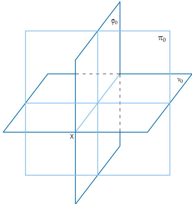
Para determinar a localização exata de um ponto, é considerado um plano de referência, perpendicular aos planos de projeção. Assim, este plano permite determinar a abcissa de um ponto, dependendo se o ponto se encontra à esquerda do referencial ou à direita do referencial. Esse plano é vulgarmente conhecido como  $\pi_0$  e corresponde à abcissa zero.
