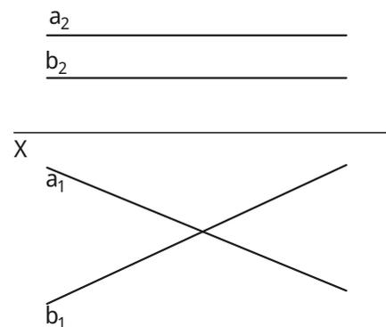
homónimas não são paralelas entre si, mas também não são concorrentes, porque, embora as projeções horizontais sejam concorrentes, em projeção frontal pode verificar-se que as retas não se interseitam.
