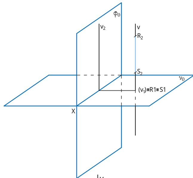
Em dupla projeção ortogonal, o comprimento real do segmento **[RS]** pode ser medido, diretamente, na sua projeção frontal.
