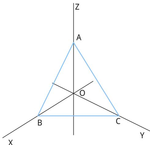
Com base neste princípio, é possível, através do **triângulo fundamental**, chegar à representação dos eixos coordenados no plano axonométrico.
