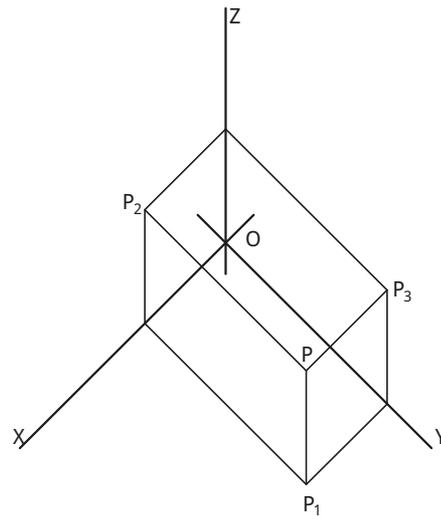
No caso da perspectiva cavaleira, determina-se que o coeficiente de redução é  $0,5$  ( $1/2$ ). Assim, as coordenadas são marcadas diretamente nos eixos **x** e **z**. No eixo **y**, o valor deverá ser reduzido para metade. Considerando o mesmo ponto **P** (3; 6; 9), os valores da abcissa e da cota (3 e 9, respetivamente) deverão ser marcados diretamente nos eixos coordenados. No eixo **y**, o valor a assinalar deverá ser 3 (redução para metade do valor em verdadeira grandeza do afastamento).
