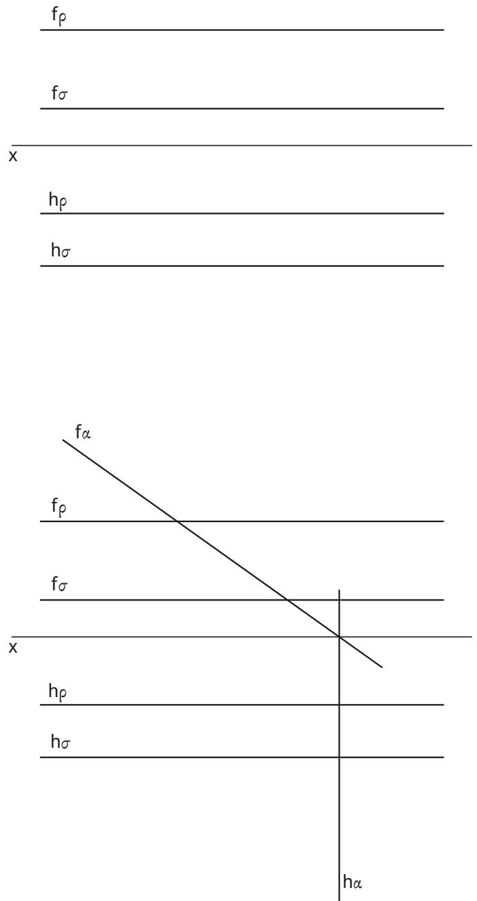
Esse ponto será determinado pela interseção de duas retas, cada uma pertencente a um dos planos. O seu ponto de concorrência será um ponto comum a ambos os planos de rampa e, conseqüentemente, um ponto da reta **i**.
