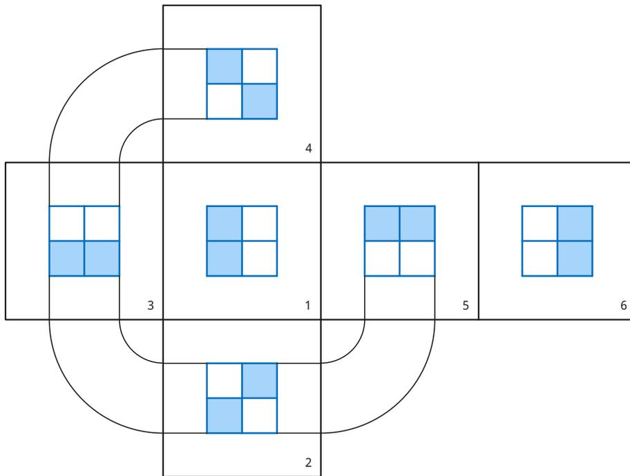
Nota que nem na projeção triédrica, nem na projeção hexaédrica há deformação da realidade – as dimensões e o aspeto não se alteram, qualquer que seja a posição do objeto relativamente aos planos de projeção. Deste modo, estes são sistemas muito utilizados no desenho técnico, no qual é necessário um elevado nível de rigor, uma vez que estes desenhos são, geralmente, utilizados em projetos de engenharia ou arquitetura.
