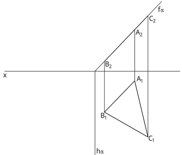
No plano do desenho, a origem dos arcos de rebatimento será onde a charneira intersecta o eixo  $x$ . A partir daí, as projeções frontais dos vértices do triângulo devem ser transportadas para o eixo  $x$ .
