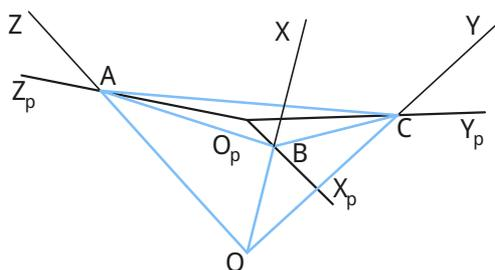
Uma vez que o plano projetante de cada eixo é simultaneamente perpendicular ao plano axonométrico e ao plano coordenado constituído pelos dois eixos restantes, e que cada um dos lados do triângulo fundamental está contido na reta de interseção do plano axonométrico com cada um dos planos coordenados, pode atribuir-se o princípio da ortogonalidade. Assim, é possível concluir que a perspectiva de cada eixo é perpendicular ao lado oposto do **triângulo fundamental**.
