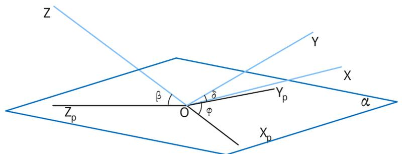
Assim, além de se tratar de um **triângulo escaleno**, os eixos coordenados representados no plano axonométrico também formam ângulos diferentes entre si, havendo três amplitudes diferentes, dependentes entre si, de forma a completar  $360^\circ$ . Ou seja, dada a amplitude de dois dos ângulos, é possível determinar a amplitude do terceiro ângulo.
