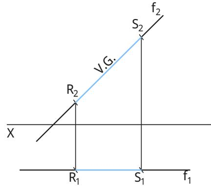
Ao observar a reta **f** no espaço, constata-se que a sua projeção frontal não sofre qualquer deformação, estando representada em verdadeira grandeza. Já a sua projeção horizontal está deformada, não sendo possível fazer uma real medição do segmento na sua projeção horizontal – **[R<sub>1</sub>S<sub>1</sub>]**.
