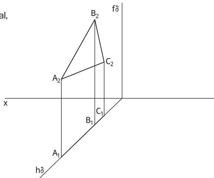
Com centro na interseção da charneira com o eixo **x**, as projeções horizontais dos pontos são transportadas para o eixo **x**, e, a partir daí, são marcadas as cotas correspondentes, resultando no rebatimento dos pontos que definem o plano vertical. Posto isto, o traço horizontal do plano vertical, após o rebatimento, fica coincidente com o eixo **x**. Já o traço frontal mantém-se, uma vez que coincide com a charneira, ou seja, rebate sobre si mesmo.
