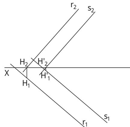
Observa as retas  $r$  e  $s$  que definem o plano. Determinados os traços horizontais de ambas as retas, a reta de interseção do plano com o Plano Horizontal de Projeção fica definida por dois pontos ( $H$  e  $H'$ ). Unindo  $H_1$  a  $H'_1$ , obtém-se a projeção horizontal da reta  $i$ . A sua projeção frontal resulta de  $H_2$  e  $H'_2$ , ou seja, é coincidente com o eixo  $x$ , uma vez que é uma reta horizontal de cota nula.
