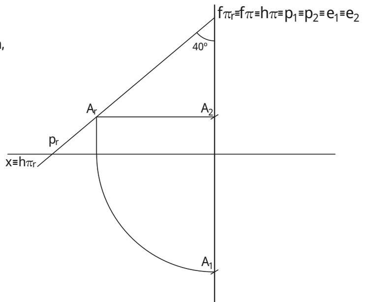
De seguida, para determinar as projeções do ponto **P**, basta seguir o processo de contra-rebatimento, ou seja: transpor as coordenadas que já são conhecidas, para as projeções da reta **p**.
