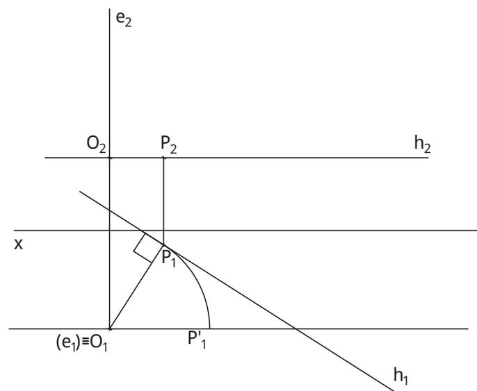
Nota que, quando o eixo de rotação é vertical, o plano dos arcos de rotação é horizontal, perpendicular ao eixo; quando o eixo de rotação é de topo, o plano dos arcos de rotação é frontal, perpendicular ao eixo.
