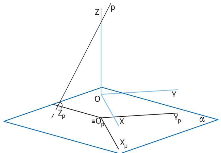
Contudo, embora nas axonometrias oblíquas a projeção não sofra alterações se o plano axonométrico for coincidente ou paralelo ao plano coordenado, haverá, sim, alterações, dependendo do plano coordenado em questão.
