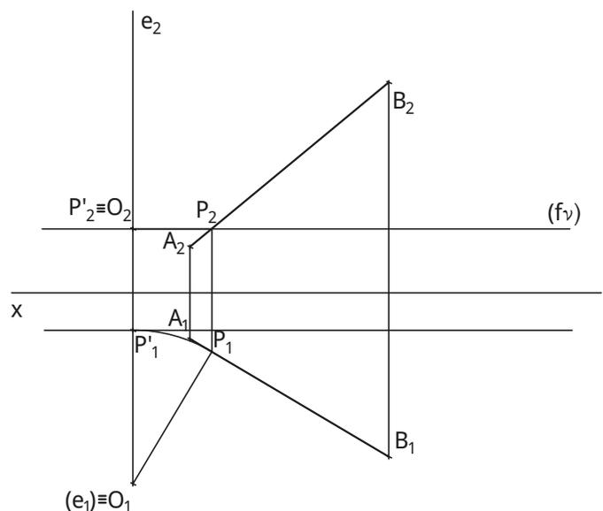
Efetuada a rotação do ponto **P** e determinadas as projeções do mesmo após a sua rotação, é possível determinar o afastamento do segmento após a rotação, uma vez que, tratando-se de um segmento frontal, todos os seus pontos terão afastamento igual.
