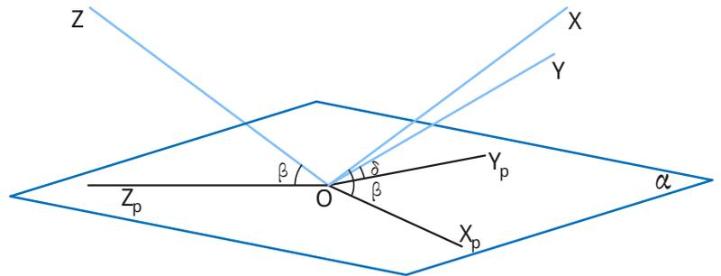
Neste caso, nenhum dos ângulos pode apresentar uma amplitude fixa. Ou seja: se o ângulo entre **x** e **z** for de  $100^\circ$  e este for igual ao ângulo formado por **y** e **z**, o ângulo diferente, formado por **x** e **y**, terá  $160^\circ$ . No entanto, se o ângulo entre **x** e **y** for de  $140^\circ$ , os dois restantes serão, obrigatoriamente, de  $110^\circ$ . Em qualquer caso, a soma dos ângulos deverá fazer  $360^\circ$ .
