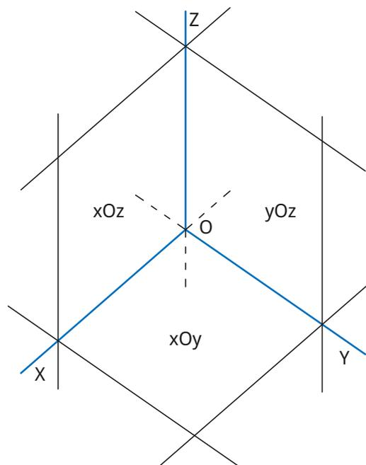
Em suma, uma perspectiva axonométrica assemelha-se a uma perspectiva cónica, representando um dado objeto de forma intuitiva e próxima da realidade tridimensional. Contudo, a diferença entre ambos os sistemas reside no facto de, no sistema axonométrico, a projeção do objeto no quadro não variar com a distância entre este e o ponto de origem dos eixos coordenados.
