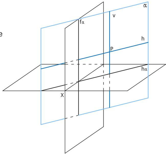
Em dupla projeção ortogonal, os traços de um plano vertical apresentam-se perpendicularmente ao eixo  $\mathbf{x}$ , no caso do seu traço frontal, e com ângulo variável entre o seu traço horizontal e o eixo  $\mathbf{x}$ , consoante o ângulo que o plano apresenta face ao Plano Frontal de Projeção.
