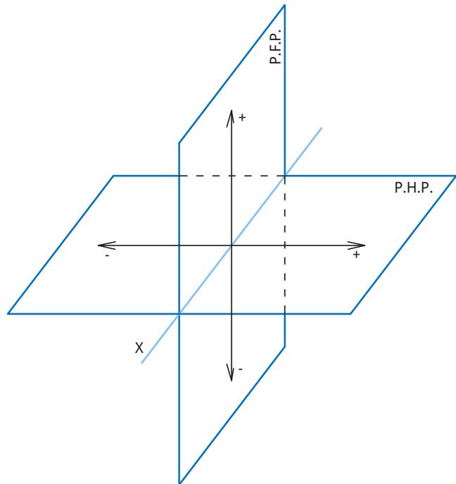
Considera o ponto **P** e as duas retas projetantes **r** e **s**. A reta **s**, perpendicular ao plano frontal de projeção, é uma reta projetante frontal que contém o ponto **P**, e a reta **r**, perpendicular ao plano horizontal de projeção, é uma reta projetante horizontal que contém o ponto **P** (**r** e **s** são concorrentes no ponto **P**).
