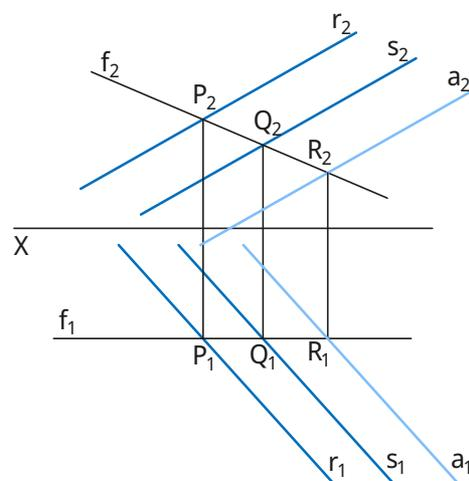
complanar com estas, qualquer reta cujas projeções sejam paralelas a  $r$  e  $s$  e que seja concorrente com a reta  $f$  é uma reta do plano paralela às retas  $r$  e  $s$ . Assim, a partir de um qualquer ponto da reta  $f$  (por exemplo, o ponto  $R$ ), traça-se a reta  $a$ , concorrente com  $f$  e paralela a  $r$  e  $s$ . As quatro retas pertencem ao mesmo plano.
