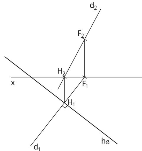
Encontrado o ponto no eixo  $x$  em que os traços se cruzam (sabendo que em casos de planos que interseitam ambos os planos de projeção, os seus traços convergem com o eixo  $x$  no mesmo ponto), o traço frontal do plano passa a estar definido por dois pontos (ponto  $F$  e ponto de convergência com  $h_\alpha$ ).
