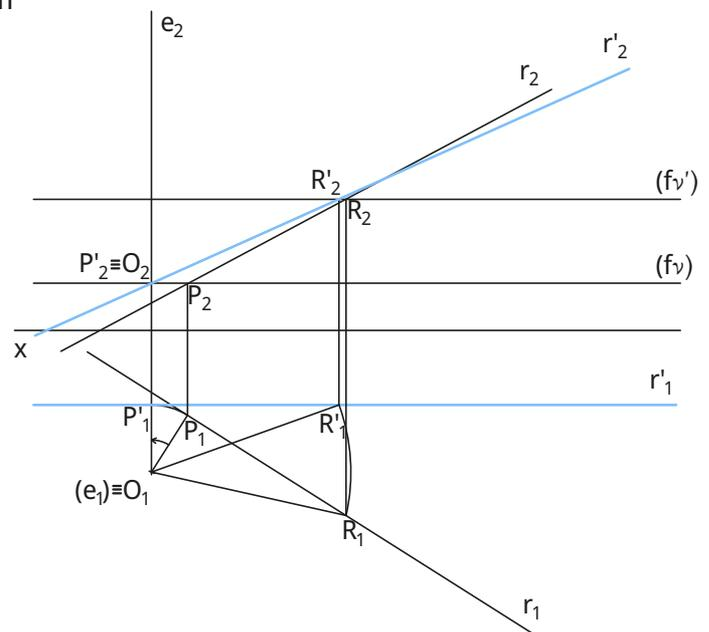
A rotação pode, por isso, ser um processo para determinação da verdadeira grandeza de um dado elemento geométrico.
