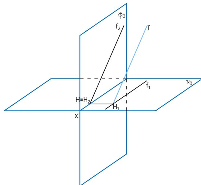
Em dupla projeção ortogonal, a projeção frontal da reta **f** – **f<sub>2</sub>** – forma um determinado ângulo com o eixo **x** (o mesmo ângulo que a reta faz com o Plano Horizontal de Projeção) e a projeção **f<sub>1</sub>** é paralela a **x**.
