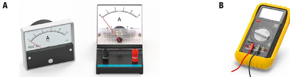
**Fig. 8A** Amperímetros analógicos. **B** Multímetro digital preparado para funcionar como amperímetro.
