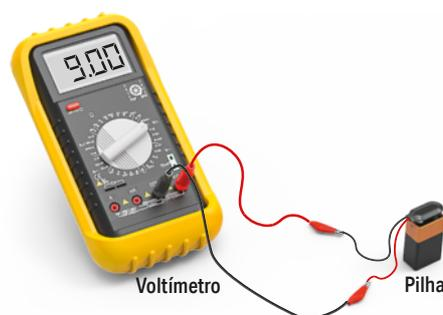
**Fig. 39** Um voltímetro ligado diretamente aos polos de um gerador de corrente contínua mede a sua força eletromotriz.
