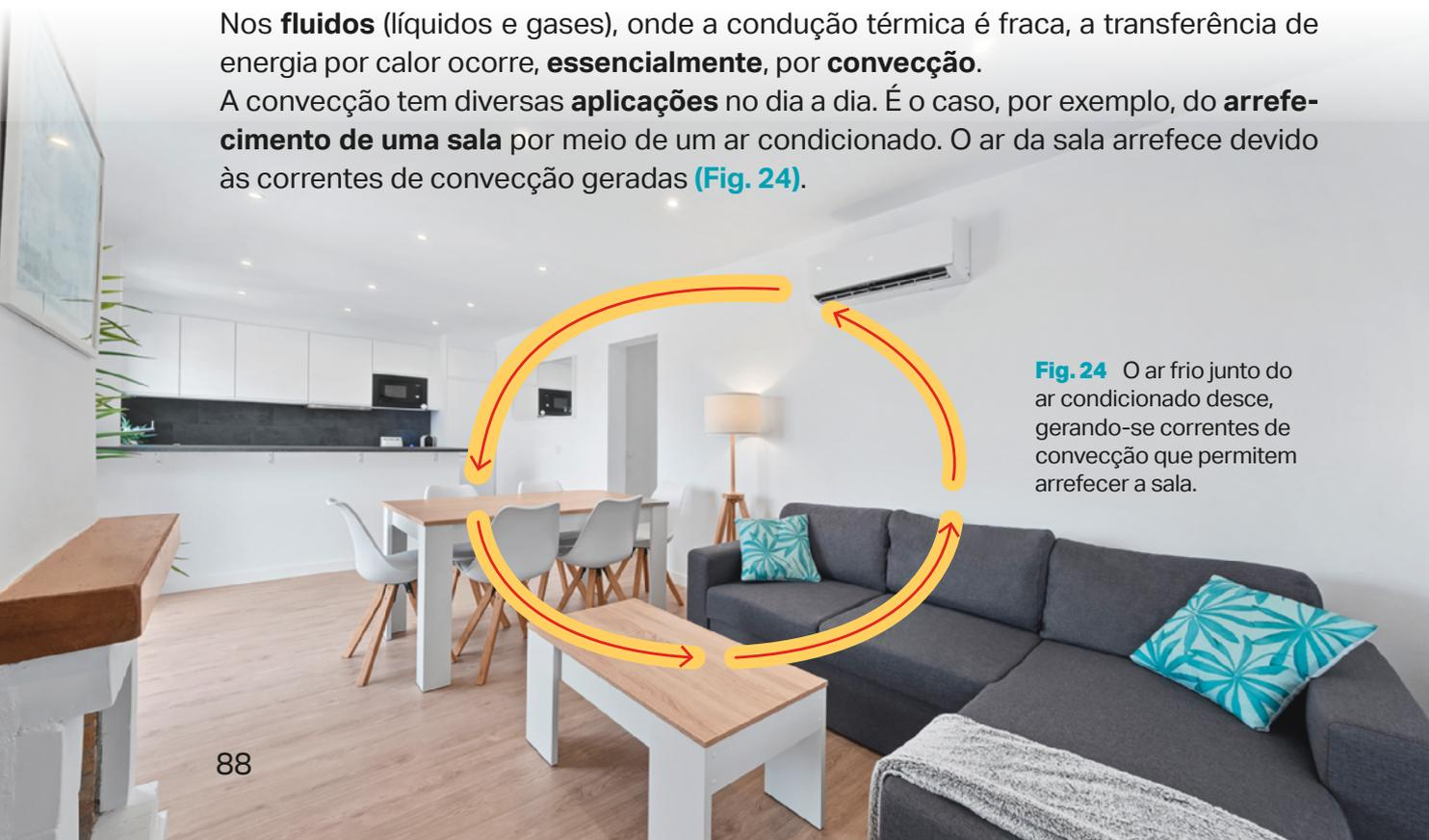
**Fig. 24** O ar frio junto do ar condicionado desce, gerando-se correntes de convecção que permitem arrefecer a sala.
