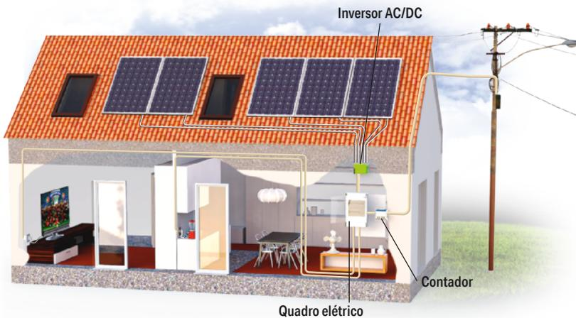
**Fig. 41** Esquema de rede elétrica numa casa com autoprodução.
