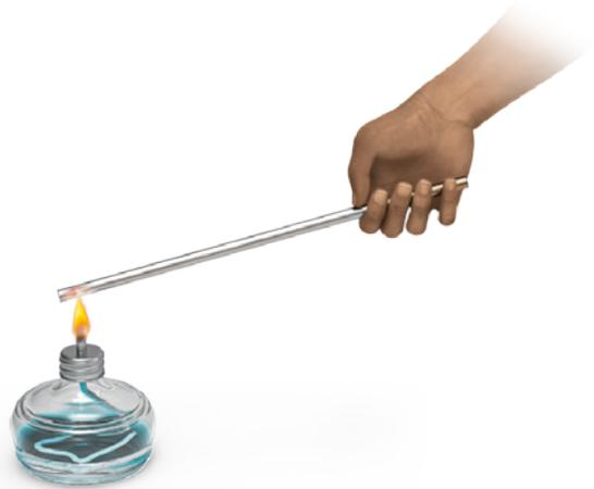
**Fig. 22** Transferência de energia por calor (condução térmica) numa barra metálica.
