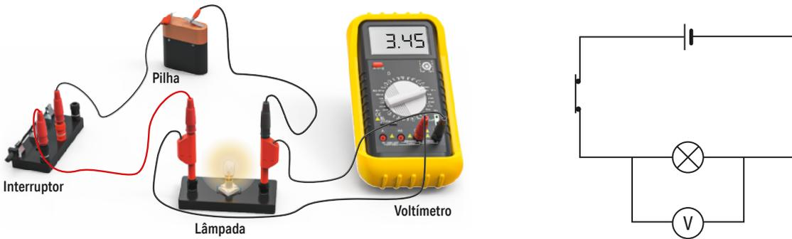
**Fig. 18** Num circuito elétrico, os voltímetros intercalam-se em paralelo.
