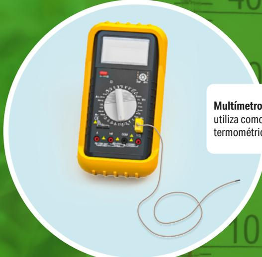
**Multímetro com termopar**, que utiliza como propriedade termométrica a força eletromotriz.
