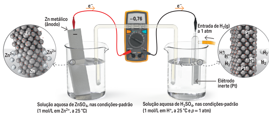
Fig. 41 Esquema de montagem de uma pilha para a determinação do potencial de elétron de um elemento metálico padrão (neste caso, o zinco).
