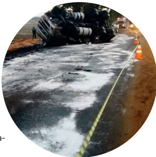
Fig. 19 Acidente com derrame de um ácido, o ácido sulfúrico, \text{H}_2\text{SO}_4 , na via. É utilizado hidróxido de sódio, \text{NaOH} , para neutralizar o ácido derramado.
